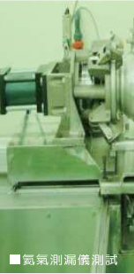
■氮氣測漏儀測試
